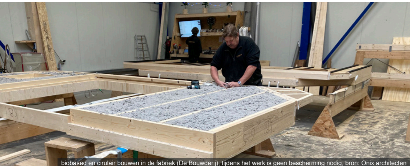
biobased en circulair bouwen in de fabriek (De Bouwderij), tijdens het werk is geen bescherming nodig, bron: Onix architecten
